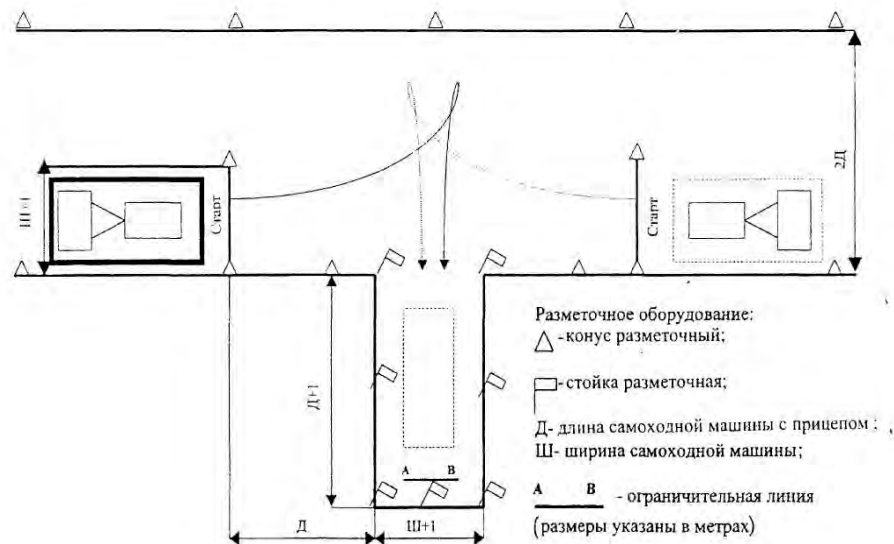
Рисунок 8 – Постановка самоходной машины в агрегате с прицепом в бокс задним ходом
